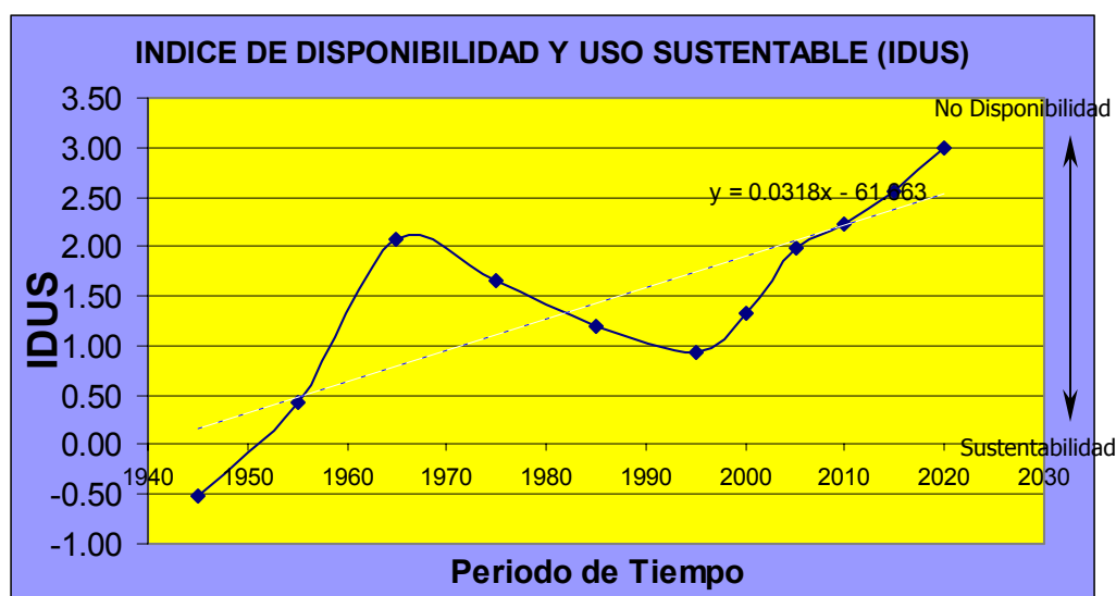
Figura 10.16 Evolución del IDUS histórico y su proyección al 2020 con escenario de sostenimiento del bombeo a una tasa de extracción actual estimada en 600 hm 3 . La línea de tendencia muestra un claro comportamiento hacia la pérdida total del recurso.
