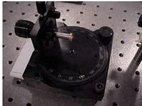
Figura 4.22 Direccionamiento de la salida de la señal óptica de la fibra hacia el detector para determinar la apertura numérica.
