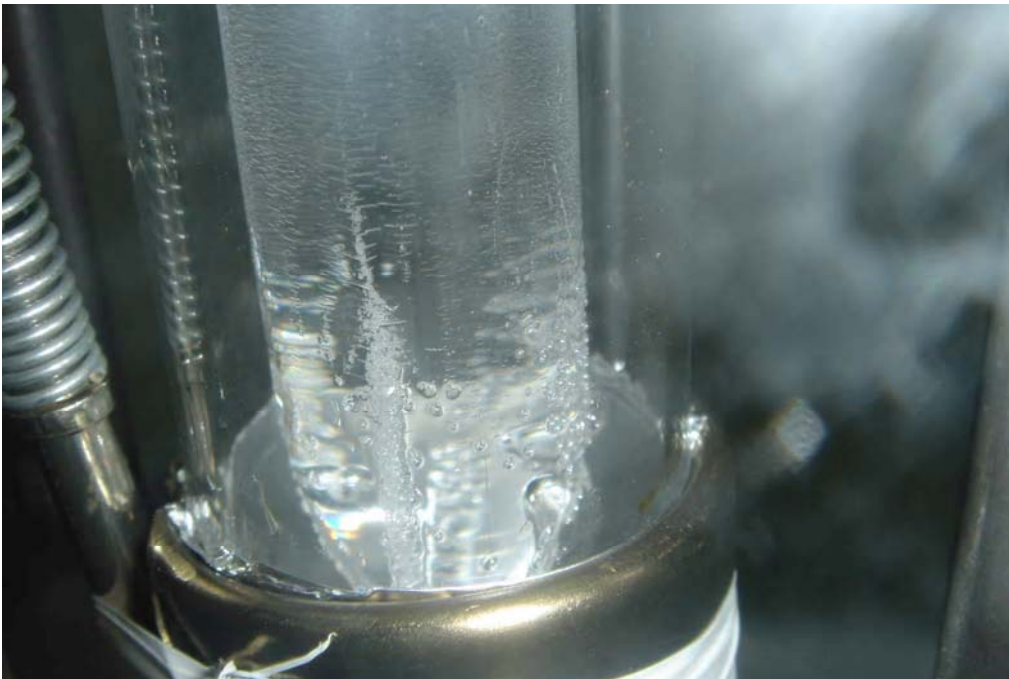
Figura 4.4 Aparición de burbujas en el cuello de la preforma al pasar por el horno de calentamiento de la torre de estirado causadas por evaporación de monómero residual en el polímero de la preforma.
