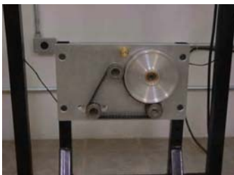
Figura 4.14 Parte inferior de la torre y traccionador.
