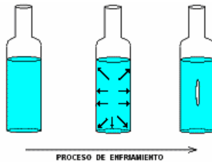
Figura 5.5 En el esquema, se ilustra el efecto del enfriamiento de la preforma después de finalizar la reacción de síntesis. En la preforma de la derecha se muestra la formación de una burbuja en el centro de la barra del polímero sintetizado por efecto de la contracción del polímero adherido a la pared de vidrio.
