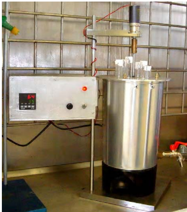
Figura 4.6 Baño térmico para el control de la temperatura durante la reacción de síntesis del PMMA.
