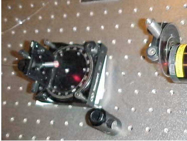
Figura 4.20 Conectorización del extremo de fibra óptica en la base con variación del ángulo de alineamiento.
