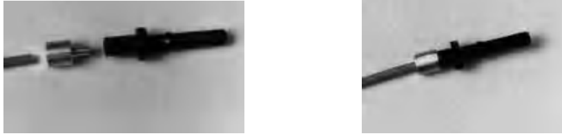
Figura 4.18 Conectorización de los extremos de fibra óptica para la evaluación de las propiedades ópticas.
