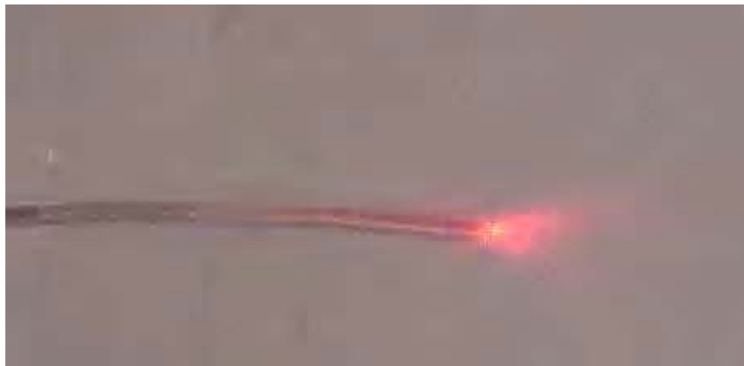
Figura 4.24 Ilustración del cono formado por la luz transmitida a la salida de una fibra óptica.
