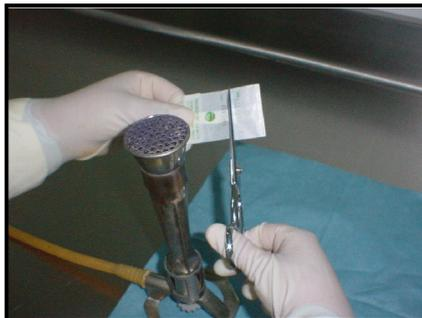
2.4. Con ayuda de una pinza esterilizada a la flama, coloque la tira en un tubo con 10 ml de Galdco Goya Tripticaseína.
