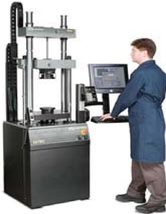
**Figura 30.- Máquina Universal de Pruebas mecánicas.**
