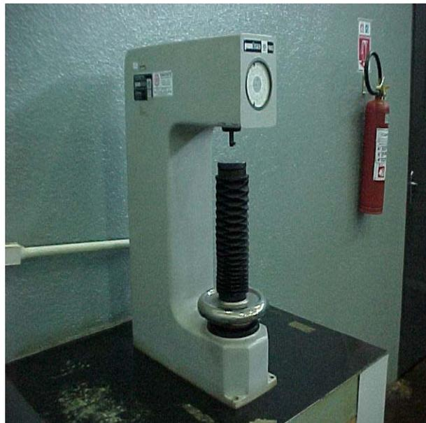
**Figura 32.- Durómetro.**
