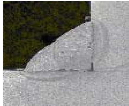
**Figura 33.- Penetración filete**
