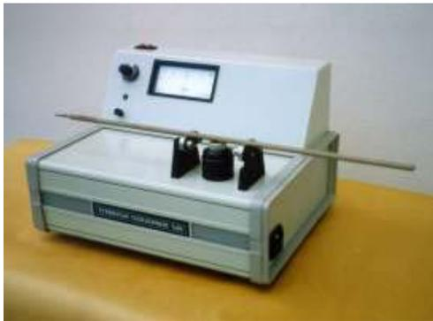
**Figura 23.- Medidor de concentricidad**
