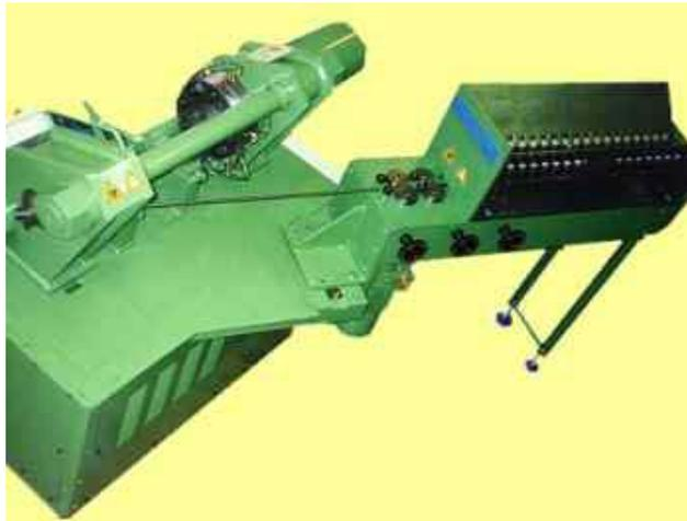
**Figura 24.- Extrusionadora y alimentadora de alambre**
