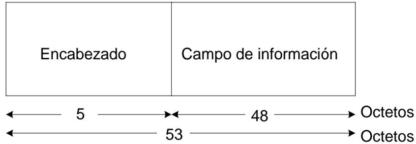
**Figura 1.12.** Estructura básica de la célula ATM.
