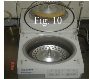
Centrífugas en frío. (Fig. 8) Microcentrífuga (Mikro 22 R, Hettich) con capacidad para 24 micro tubos eppendorf. (Fig. 9) Centrífuga (Hermle 2400k, Lab-Tec) de 4 puntos con vasos intercambiables para tubos de distinto volumen. (Fig. 10) Microcentrífuga de vacío (Vacufuge, Eppendorf) con capacidad para 48 micro tubos. Todas las centrifugas se pueden ajustar en cuanto a tiempo, temperatura y revoluciones por minuto (rpm).
