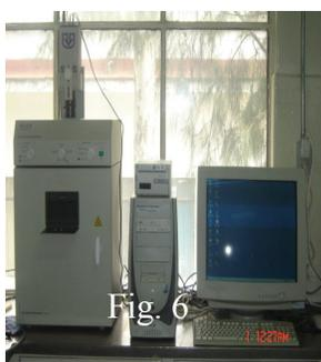
(Fig. 6). Fotodocumentador (Epicchemi II Darkroom, UVP. Biolenaging Systems) Cámara digital unida a una computadora. (Fig. 7) La recamara (B) cuenta con una lámpara de luz ultravioleta que hace posible la luminiscencia de ciertos reactivos como el bromuro de etidio. Para fotografiar corridas de proteínas se usa una pantalla (a) que convierte la luz ultravioleta en luz blanca.
