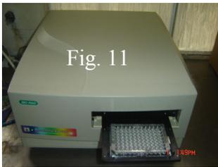
(Fig. 11) Espectrofotómetro (Benchmark plus, Bio-Rad). Es un equipo ampliamente usado para investigación en pruebas como ELISA, Interferón gamma, cuantificación de proteínas. Este modelo puede leer placas de 96 pozos con capacidad de 200  $\mu$ l cada uno, lo que permite economizar muestra y reactivos. También está conectado a una computadora que captura las lecturas y permite su análisis e interpretación con mayor facilidad.
