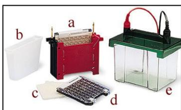
Equipo para la transferencia de proteínas a matrices inertes (mini- transblot cell, Bio-Rad). (a) Cartucho de transferencia. (b) molde refrigerante. (c) Fibra y papel filtro. (d) Prensa de armado para el sándwich. (e) Cámara de corrida. Es un componente del Mini-PROTEAN 3, El Mini Transblot cell acomoda dos prensas para la transferencia, que se realiza en la misma cámara de corrida.
