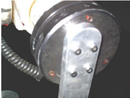
Figura 3.9 Soporte de la Pistola Rociadora acoplada al brazo mecánico
