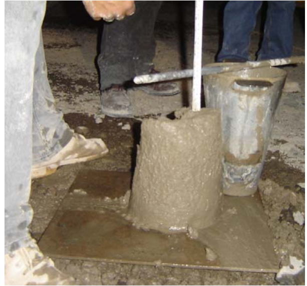
Figura 6. Prueba de revenimiento
