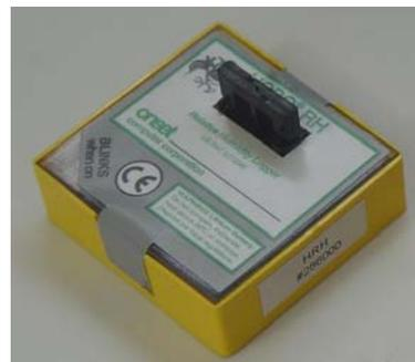
Foto 8. Sensor de humedad relativa (tomada por Stanford, 2005).
