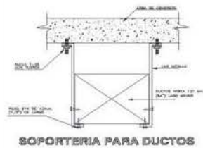
SOPORTERIA PARA DUCTOS
