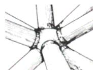
Fig. 14. Nodo del sistema Oktaplatte.
