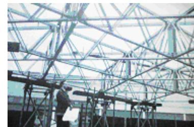
Foto 7.- Sistema Met-Ram bajo pruebas de carga en la Universidad de Londres.
