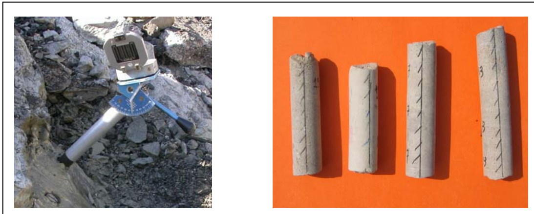
Figura 7. En esta figura se muestra como se orientan y marcan las muestras obtenidas en el campo.
