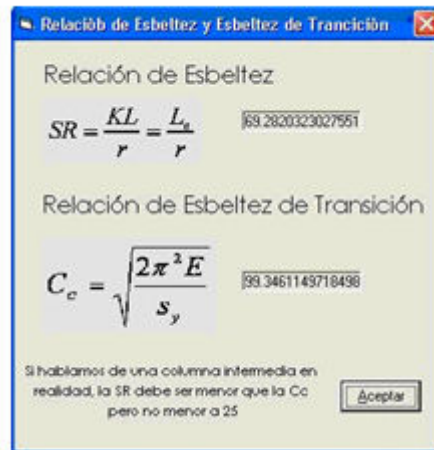
Figura 3.11 Resultados del cálculo de la relación de esbeltez y esbeltez de transición
