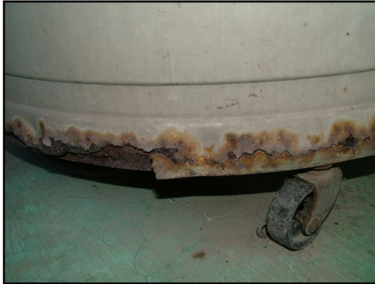
Figura 1.4 Lavadora doméstica que presenta corrosión en grietas o hendiduras.
