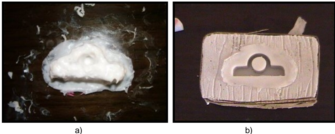
Figura 4.24 a) Caucho sobre la muestra del soporte para hacer el molde; b) Molde de caucho dentro de una base de yeso.
