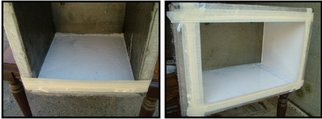
Figura 4.8 a) Pigmento blanco sobre una cara del interior del tanque; b) Pared cuadrada con doble capa de pigmento.
