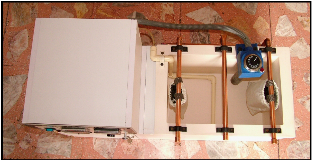
Figura 4.75 Vista superior del sistema de electrodeposición terminado.
