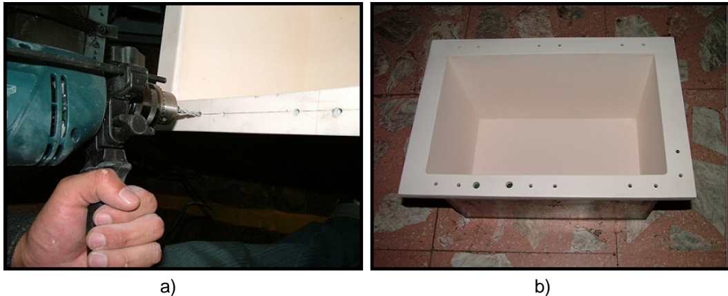
Figura 4.12 a) Perforación de la tina; b) Tina con todas las perforaciones.
