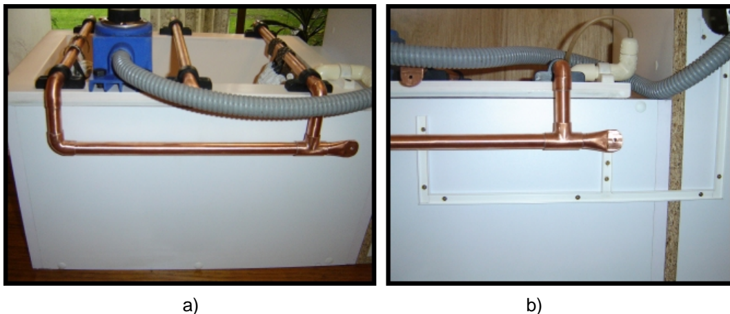
Figura 4.65 a) Colocación del tanque en el mueble. b) Barras conductoras alineadas con la canaleta del mueble.
