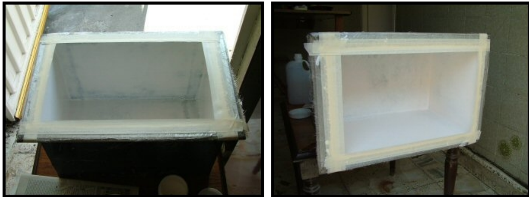
Figura 4.9 a) Interior del tanque con pigmento; b) Paredes con varias capas de resina y pigmento.
