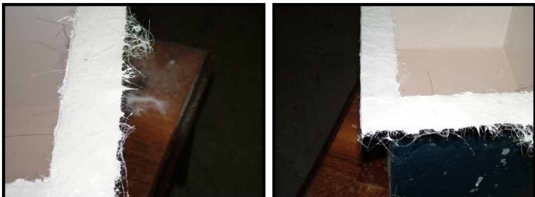
Figura 4.10 Acabado en bruto de las pestañas recubiertas con fibra de vidrio.
