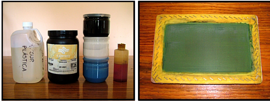
Figura 4.45 a) Pintura y solventes para serigrafía; b) Malla sin destapar.
