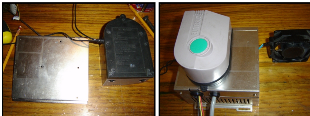
Figura 4.55 a) Tapa superior de la fuente perforada; b) Bomba colocada en la fuente.
