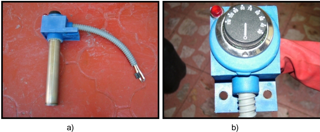
Figura 4.34 a) Calentador de 500 Watts; b) Termostato del calentador.
