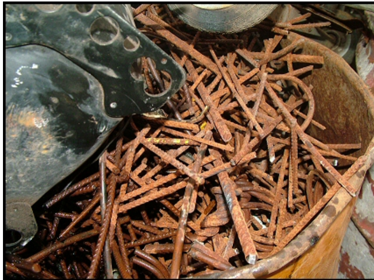
Figura 1.2 Varillas que presentan corrosión uniforme.
