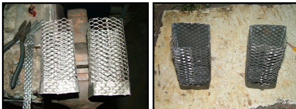
Figura 4.17 Cuerpo cerrado de las nuevas canastillas
