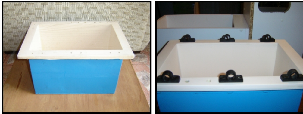
Figura 4.61 a) Tanque sin soportes; b) Soportes atornillados al tanque
