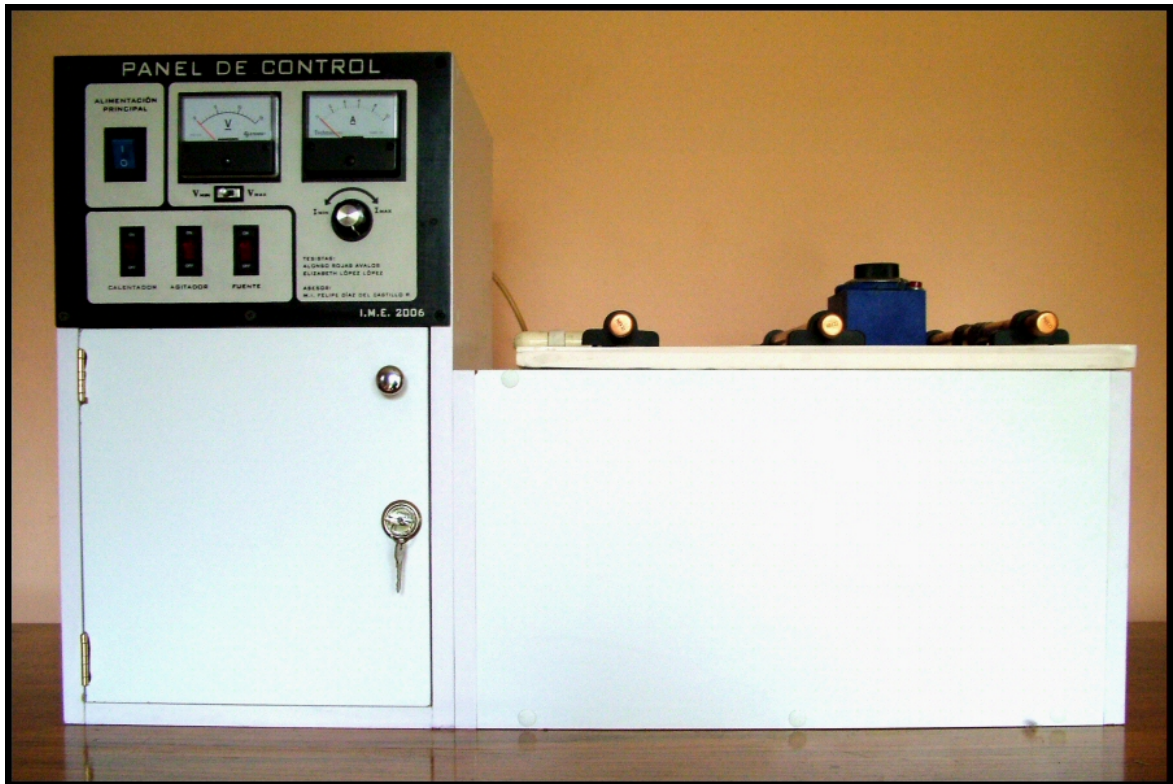
Figura 4.73 Vista frontal del sistema de electrodeposición terminado.
