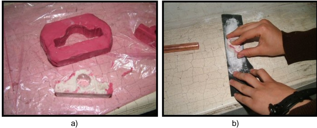
Figura 4.23 a): muestra en bruto, b) lijado de la muestra.
