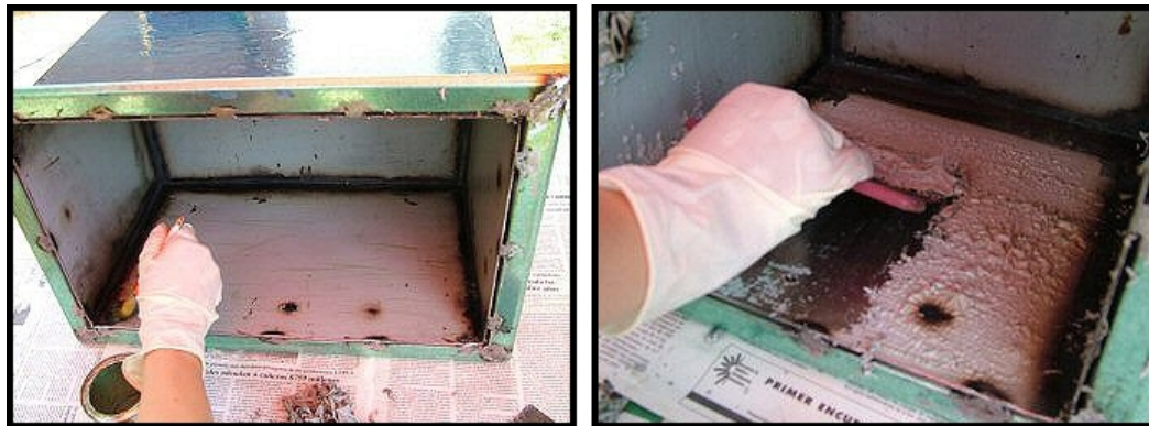
a) Aplicación de removedor de pintura; b) Desprendimiento de la pintura con espátula.
