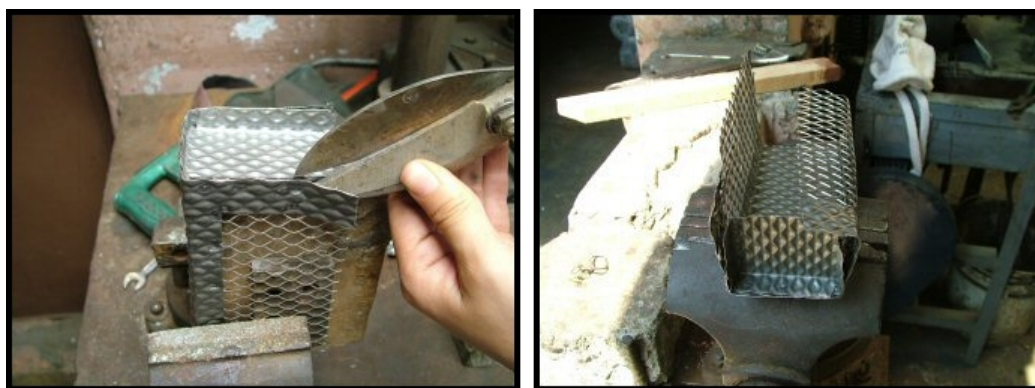
Figura 4.16 a) Corte en la base para permitir el doblar; b) Formado del cuerpo.
