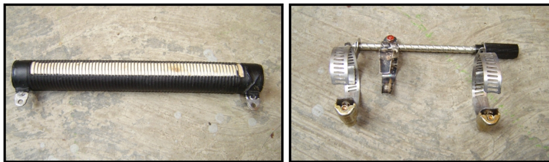
Figura 4.56 a) Resistencia de 10\Omega a 100W ; b) Dispositivo mecánico para controlar la resistencia.
