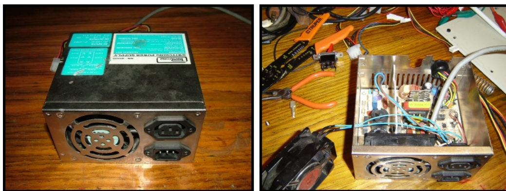
Figura 4.54 a) Fuente original; b) Ventilador exterior adaptado.
