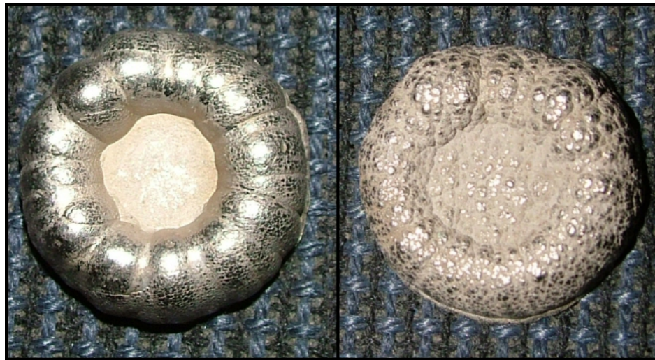
Figura 1.3 a) Níquel en estado puro. b) Níquel después de ser utilizado en el proceso de electrodeposición.
