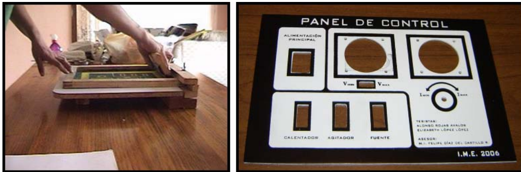
Figura 4.48 a) Impresión de la placa; b) Panel de control impreso.
