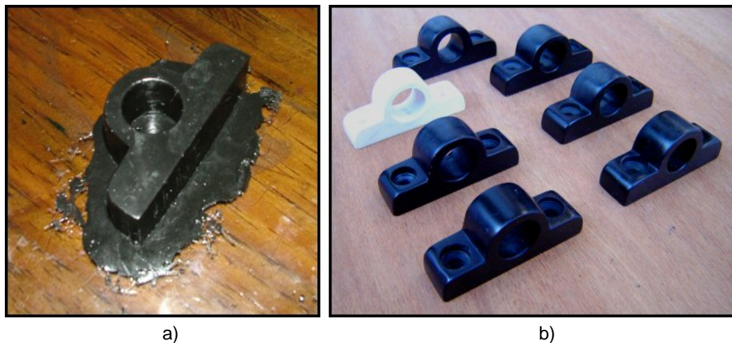
Figura 4.27 a) Soporte extraído del molde; b) Soportes lijados y perforados.
