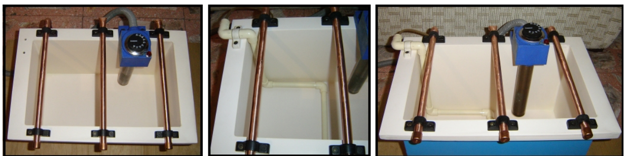
Figura 4.63 a) Calentador colocado; b) Posición del agitador dentro del tanque; c) Tanque con los accesorios.
