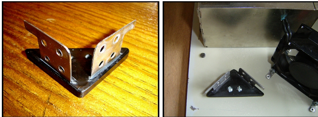
Figura 4.60 a) Terminales generales; b) Terminales atornilladas a la base principal.
