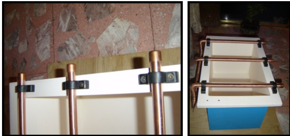
Figura 4.62 a) Tapones colocados en los extremos de las barras; b) Vista de las barras anódicas colocadas.
