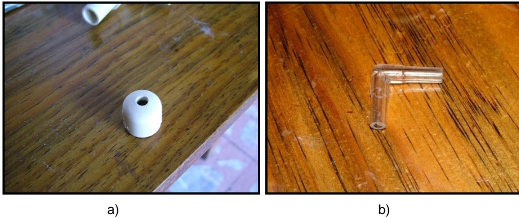
Figura 4.32 a) Tapón perforado; b) Accesorio empleado como cople para unir a la manguera con el adaptador.
