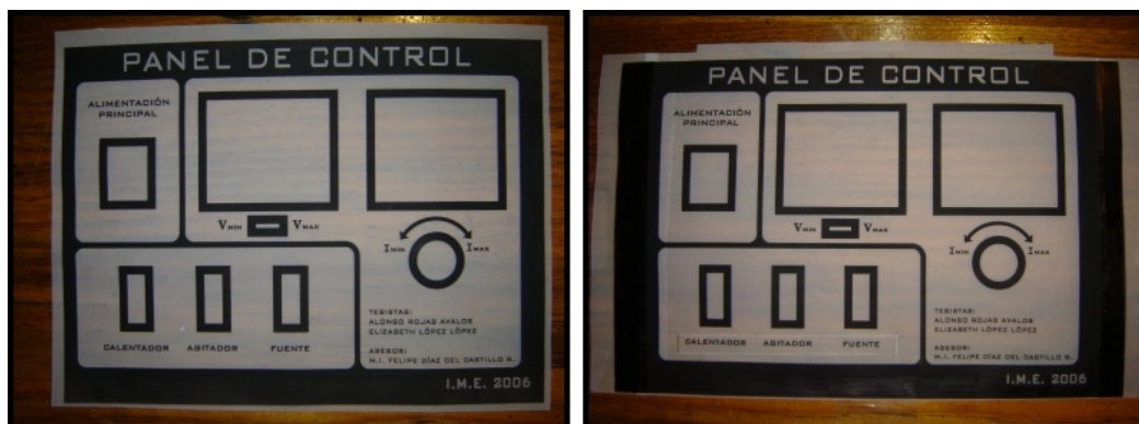
Figura 4.44 a) Impresión en albanene; b) Positivo con los ajustes.
