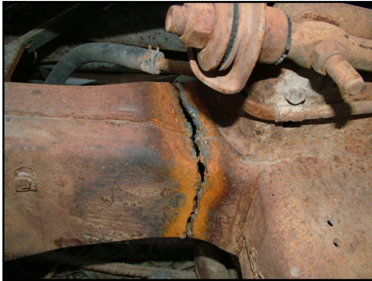
Figura 1.9 Eje de automóvil que falló a causa del efecto de la corrosión bajo esfuerzo.
