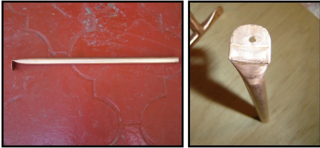
Figura 4.40 a) Dobleza en uno de los extremos; b) Extremo perforado.
