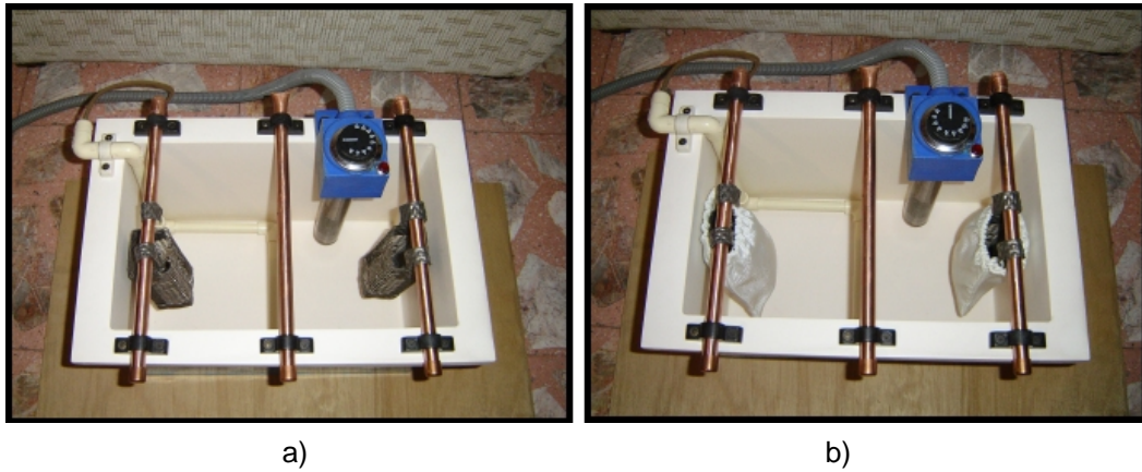
Figura 4.64 a) Ubicación de las canastillas en el interior del tanque; b) Colocación de las canastillas en el tanque.
