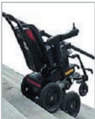
Silla de ruedas electrónica con dispositivo nivelador para subir y bajar escaleras.
