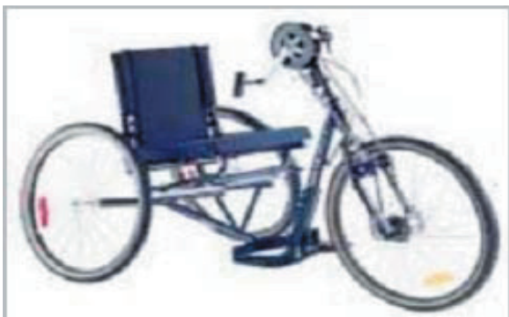
Mecanismo de impulso por tracción delantera para silla de ruedas activa.
