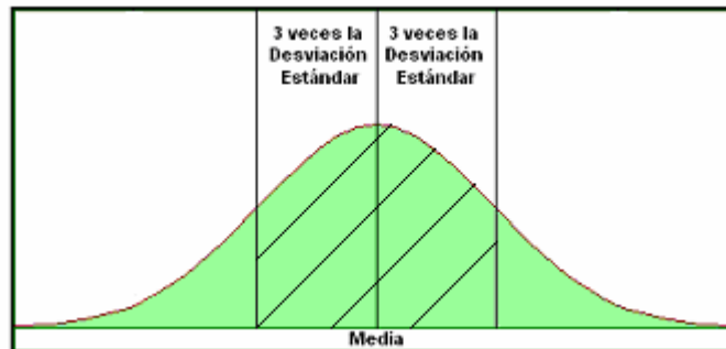
Figura 1.1. Curva normal de un proceso centrado.
