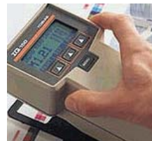
Fig. 55 Densitómetro portátil que muestra la ganancia de punto, contraste, errores de tonalidad y grises.
