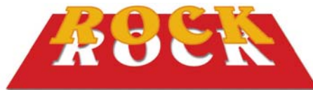
Fig. 42 En el trapping el color de abajo no se afecta por el que cae encima, pues aparece calado.
