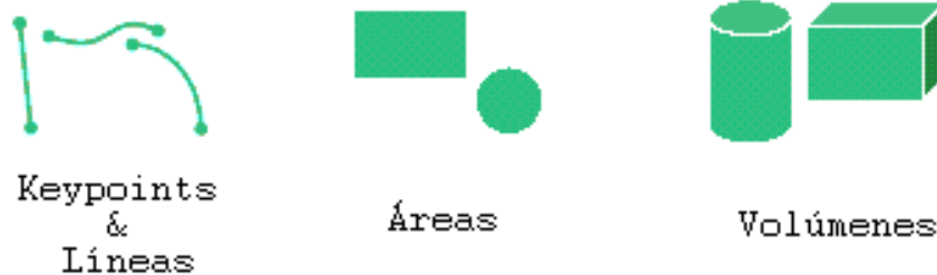
Figura 3.1 Elementos empleados para definir un modelo sólido.
