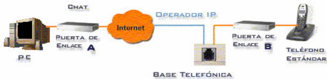
Figura 3.12 Llamadas PC a teléfono y viceversa
