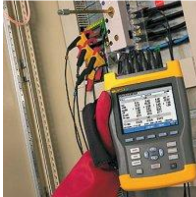
Figura III.VII.8 Analizador de calidad de energía Fluke serie 430
