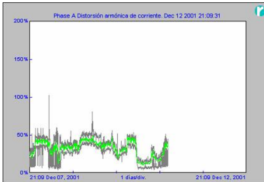
Figura V.1.19 Forma de onda de la distorsión de corriente de la fase A
