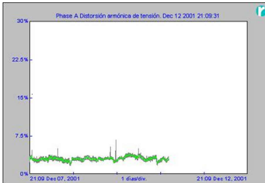
Figura V.1.16 Forma de onda de la distorsión de tensión de la fase A
