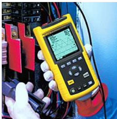
Figura III.VII.1 Analizador de Calidad de Energía Fluke 43B
