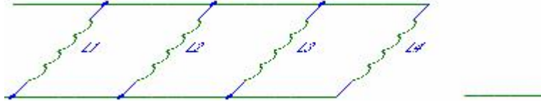
Figura I.I.23 Diagrama de conexiones de inductores en paralelo
