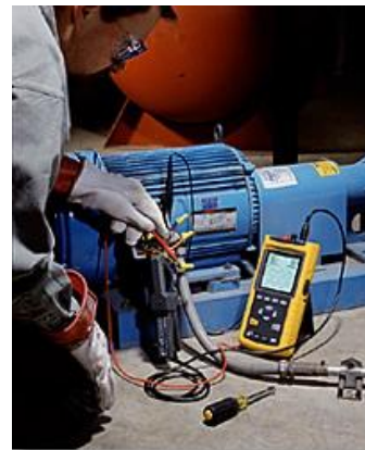
Figura III.VII.1 Analizador de Calidad de Energía Fluke 43B
