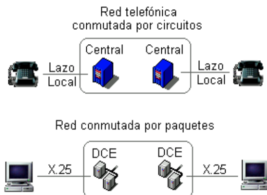
Figura 2.16 El protocolo X.25 comparado con el lazo local telefónico
