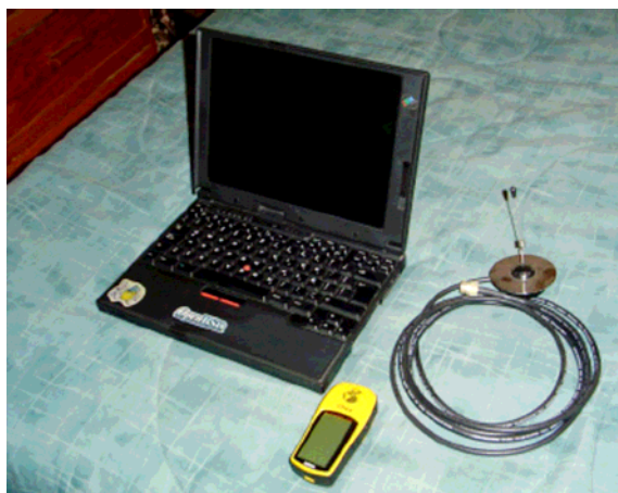
Figura 1. Equipo utilizado para el mapeo de redes
