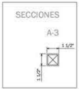
VISTA DE ESTRUCTURA TUBULAR DE CUBIERTA
