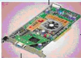
Cuando estos datos digitales provenientes del microprocesador llegan a la tarjeta de video, son convertidos en señales eléctricas que se envían hacia el monitor, y finalmente, en este dispositivo se convierten en las imágenes que aparecen en la pantalla.
