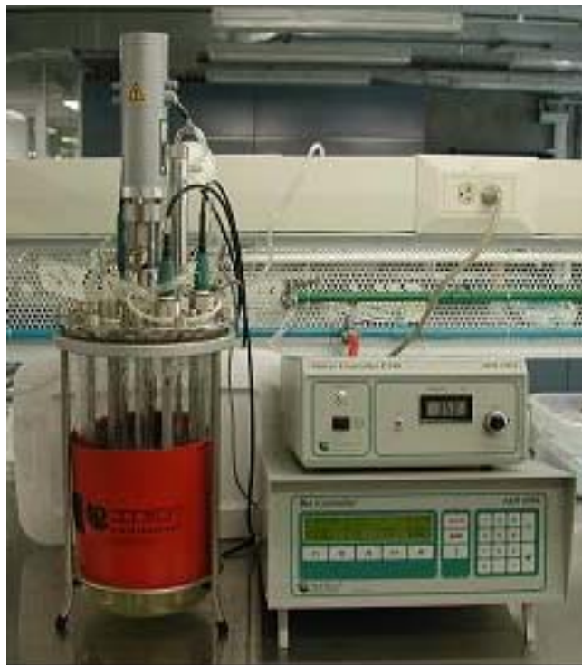
Figura 3.3 Reactor aerobio SBR para el cultivo de Pseudomonas aeruginosa ATCC 10145
