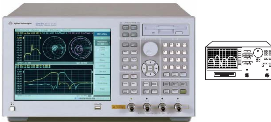
Fig. 5.1 Analizador de redes. Permite la medición de parámetros como la relación de onda estacionaria y atenuación en función de la frecuencia e impedancia de entrada a partir de la carta de Smith.
