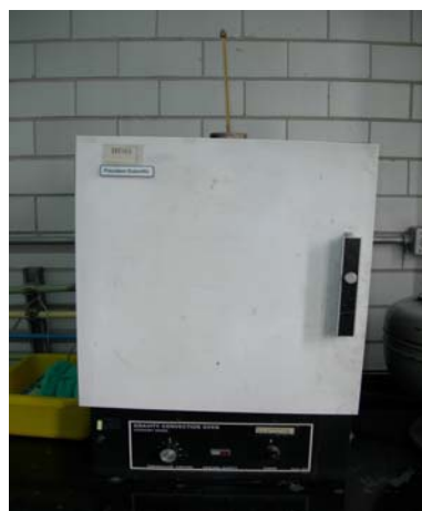
Fotografía 11. Mufla y estufa para determinar SST y SSV.
