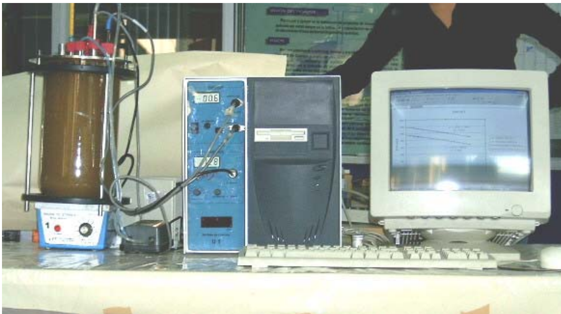
Fotografía 3. Sistema de cultivo de lodos Activados
