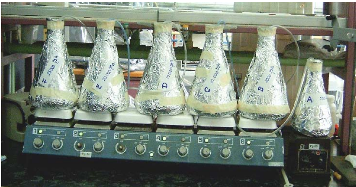
Fotografía 4. Sistema de seis reactores tipo batch
