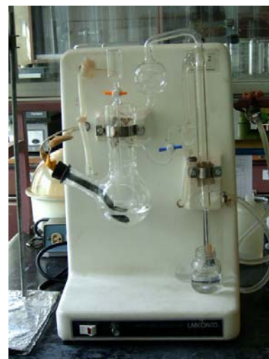
Fotografía 13. Sistema de destilación de Labconco para determinación de \text{N-NH}_4^+
