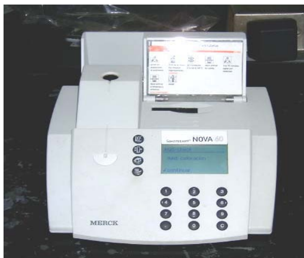
Fotografía 5. Sistema Nova 60 para la determinación de DQO, \text{N-NO}_2^- y \text{N-NO}_3^-
