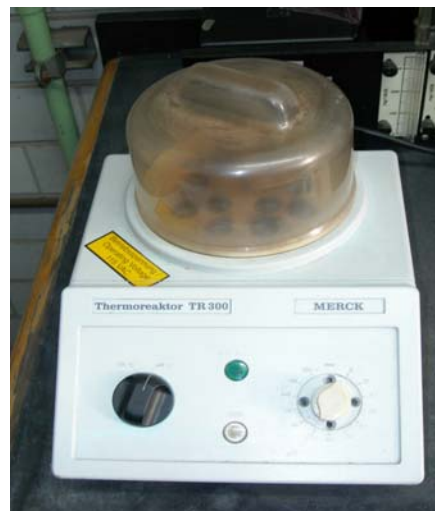
Fotografía 10. Thermorektor de Merck para digestión de muestras de DQO
