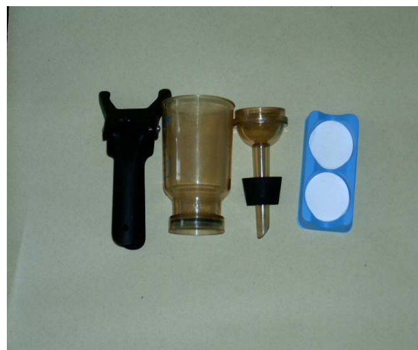
Fotografía 6. Equipo para la determinación de SST y SSV
