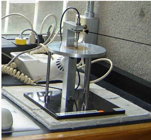
Figura No. 2 calibración del equipo de contracción
