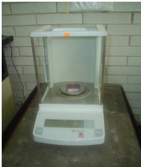
Figura No. 7 pesando la resina Venus protegida por el dispositivo oscuro.
