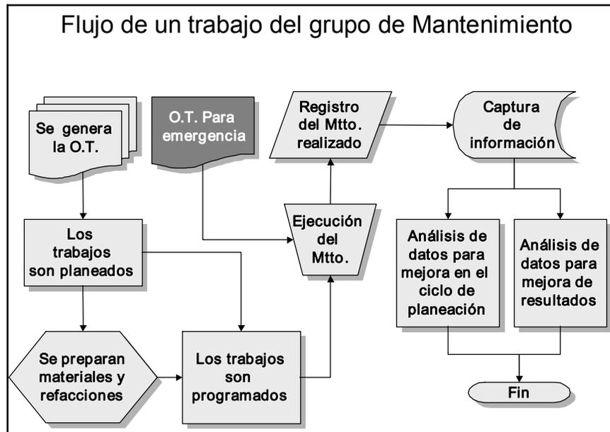
Fig. 48. Flujo de trabajo establecido para atacar los trabajos de Mantenimiento (JIPM, 2000).
