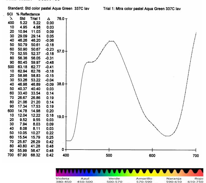
En esta gráfica se presenta una relación de la longitud de onda y el de eflectancia de la tinta color verde acuático, observándose que a nm se tiene un máximo de de eflectancia de 6., de nm a 6 nm el de eflectancia presenta un de eflectancia de . a ; en el máximo de de eflectancia nos indica una saturación del color verde, permitiendo así un comparativo para aprobar el espectro.
