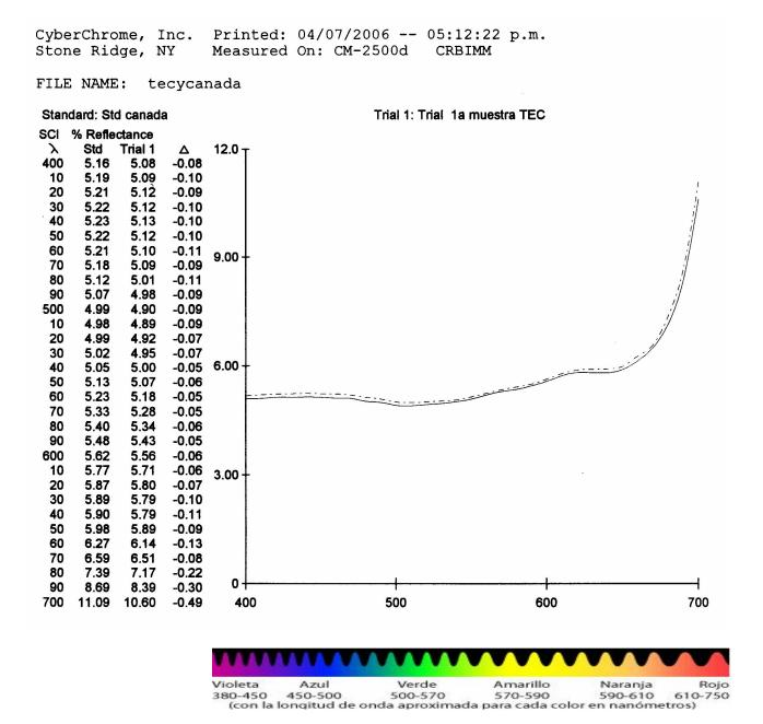
En esta gráfica se presenta una relación de la longitud de onda y el de eflectancia de la tinta permanente color negra, observándose que de nm a 6 nm se mantiene constante el de eflectancia entre . 6 a . , pero de 6 nm a nm el de reflectancia aumenta hasta indicando la ligera presencia del color rojo.
