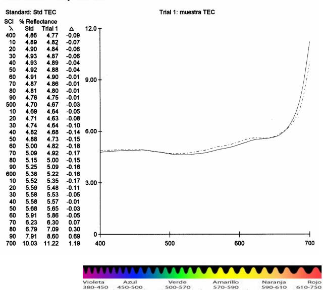
En esta gráfica se presenta una relación de la longitud de onda y el de eflectancia de la tinta permanente color negra, observándose que de nm a 66 nm se mantiene constante el de eflectancia entre . 6 a . , pero de 6 nm a nm el de reflectancia aumenta hasta . indicando la saturación del color rojo pero dentro de lo permitido para que se apruebe el espectro.
