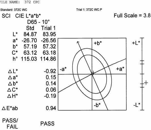
Evaluación con el espectrofotómetro de reflectancia Modelo CMd.
