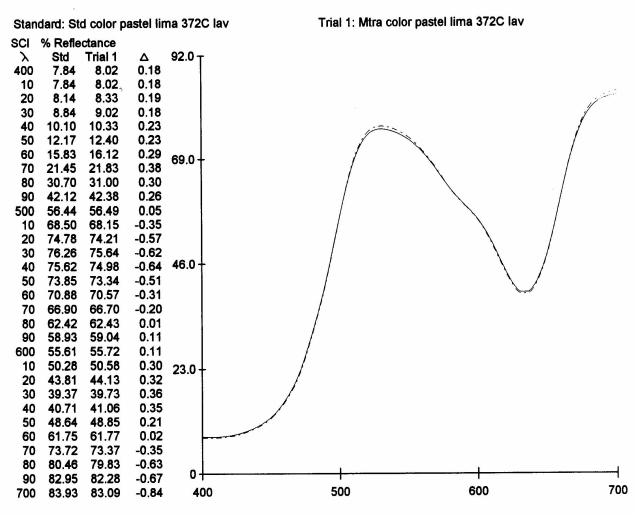
En esta gráfica se presenta una relación de la longitud de onda y el de eflectancia de la tinta color pastel lima C lavable, observándose que entre a 6 nm tiene un de reflectancia de . a . por la presencia del azul free bernacid E-C y amarillo acido y su máximo de reflectancia es de 6. a nm indicando que el estándar es más cromático comparado con la muestra y es adecuado para aprobarlo.
