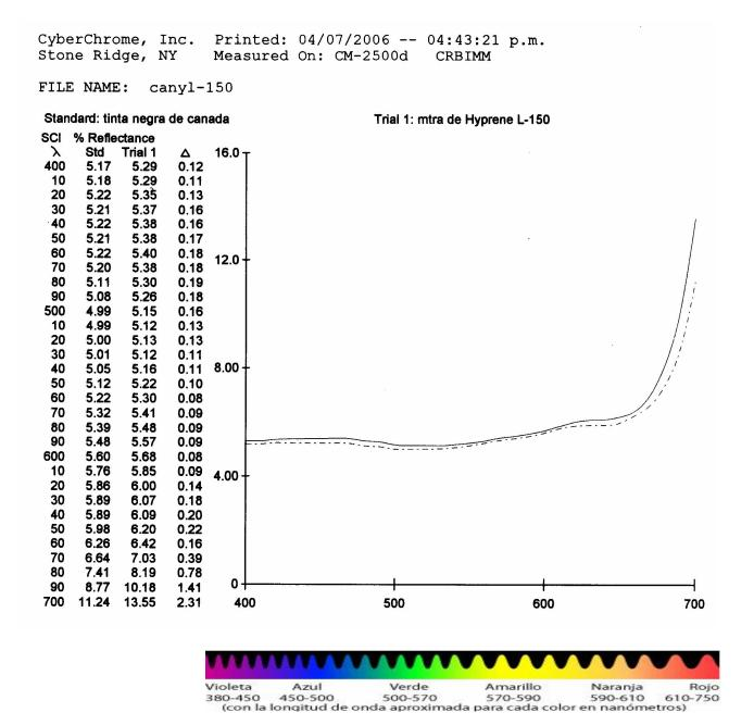
En esta gráfica se presenta una relación de la longitud de onda y el de eflectancia de la tinta permanente color negra, observándose que de nm a 6 nm se mantiene constante el de eflectancia entre . a . , pero de 66 nm a nm el de reflectancia aumenta hasta indicando la presencia del color rojo.
