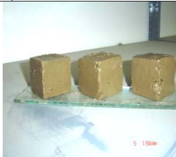
Foto 2.5 Especímenes retirados del molde para secado.
