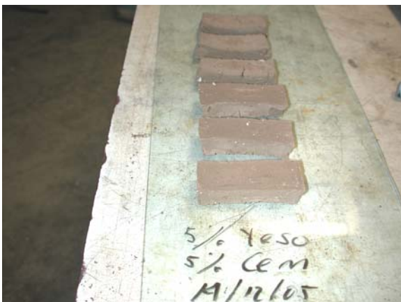
Foto 3.11 Ladrillos mezcla lodo-yeso-cemento.
