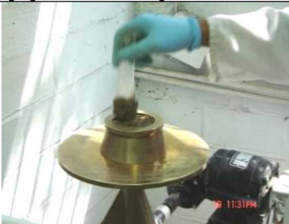
Foto 2.8 Mesa de Fluidez SOILTEST, INC CT-20-CP, Peso: 10 kg.
