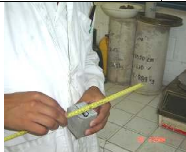
Foto 2.13 Medición del volumen del espécimen
