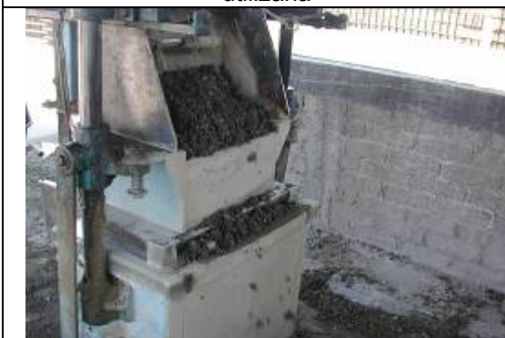
Foto 1.15 Máquina bloquera llena de mezcla
