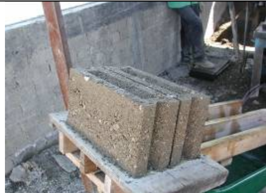
Foto 1.18 Muestra de tabicones lista para secado a temperatura ambiente
