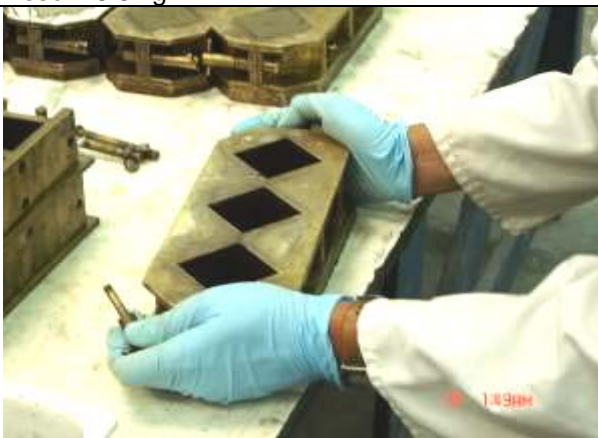
Foto 2.3 Molde para cubos de cemento ELE INTERNATIONAL.
