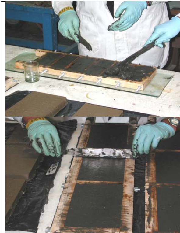
Foto 2.6 Fabricación de ladrillos pequeños y grandes a base de lodo
