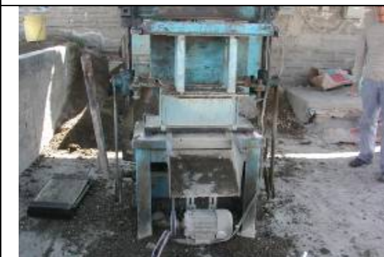
Foto 1.16 Máquina bloquera en operación
