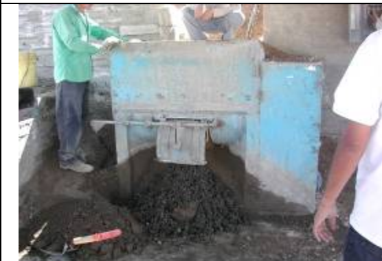
Foto 1.14 Vaciado de la mezcla
