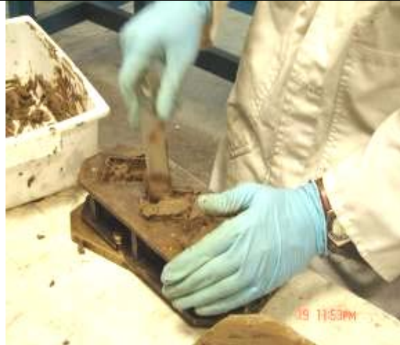
Foto 2.4 Agregado de mezcla lodo-material cementante a molde para la fabricación de especímenes.
