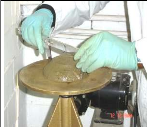
Foto 2.9 Medición de fluidez de la mezcla.
