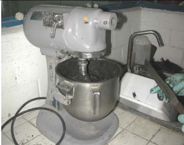
Foto 2.2 Agitador SOILTEST, INC CT-345.
