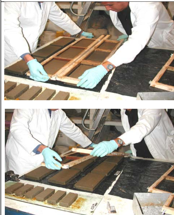
Foto 2.7 Retirada de ladrillos de los moldes.
