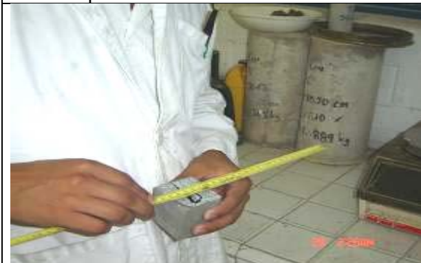
Foto 2.10 Medición del volumen del espécimen.
