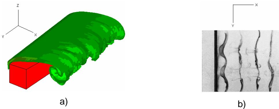
Figura 2.6 Estructura de vórtices a  $Re=164$  a) diagrama de la separación del flujo con características tridimensionales y b) fotografía de experimento a tinta [4].
