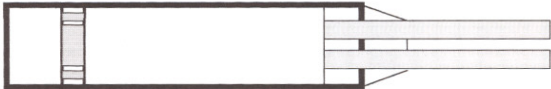
FIGURA 30. COLOCACIÓN DE LAS TUBERÍAS DE COBRE EN EL QUEMADOR.
