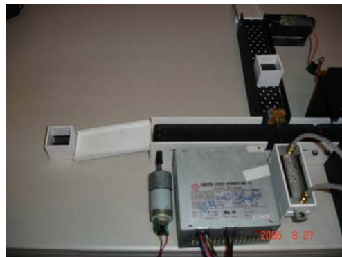
Fig. 2.6, Ubicación de sensores de presencia
