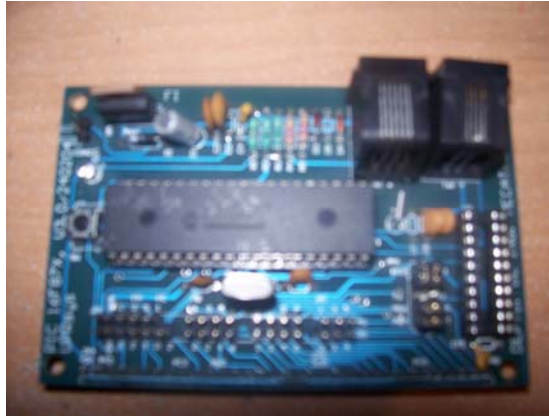
Fig. 1.25, Circuitería en tarjeta fenólica.
