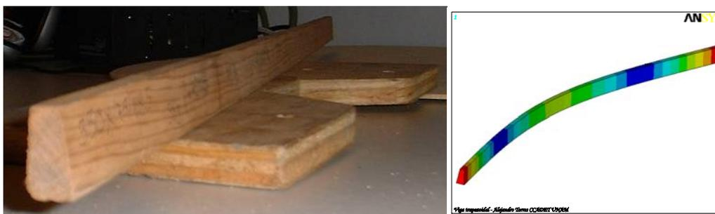
Figura 13. Perfil de la viga de sección trapezoidal (izquierda) y su primer modo de vibración libre simulado (derecha).
