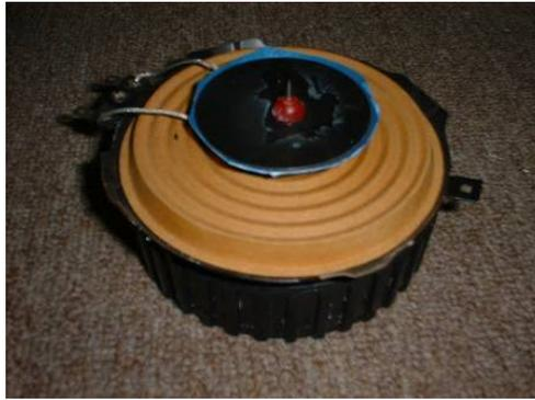
*Figura 16. Excitador electromagnético.*
