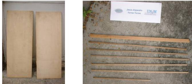
*Figura 7. Maderas para la construcción. Dos placas simétricas para la construcción de la tapa (izquierda); y seis varas para el abanico y una viga trapezoidal para las barras de la boca (derecha).*
