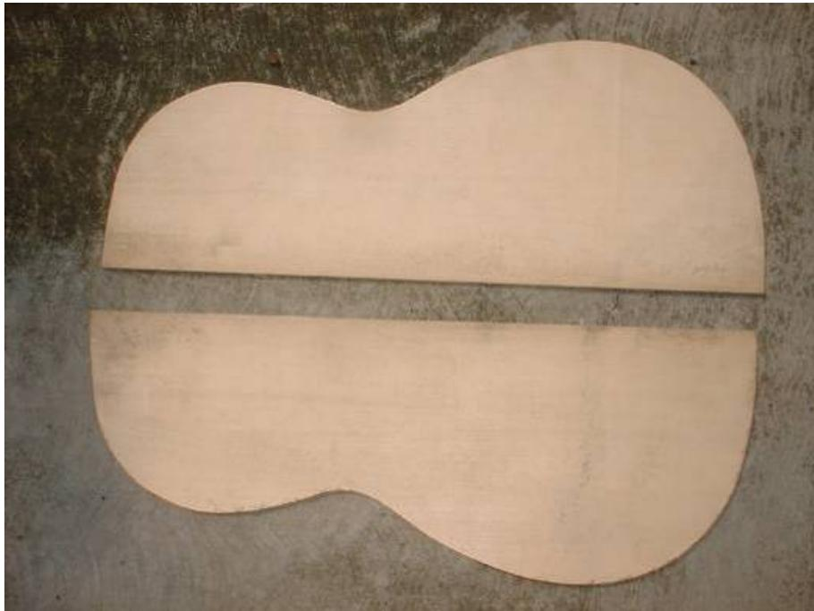
Figura 19. Placas cortadas con geometría aproximada a cada mitad de la tapa superior.
