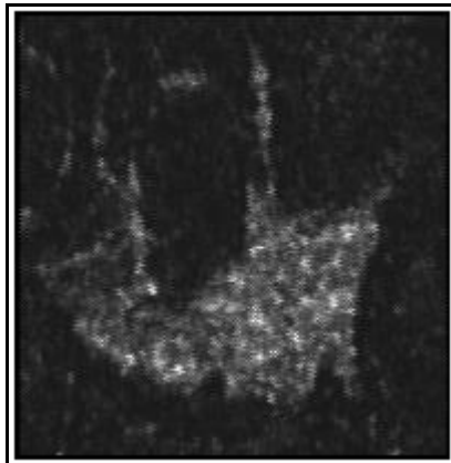
Imagen 2.9 oilenrg.raw. Aquí se muestra la imagen de textura de energía. Donde se distingue de manera regular el posible petróleo.
