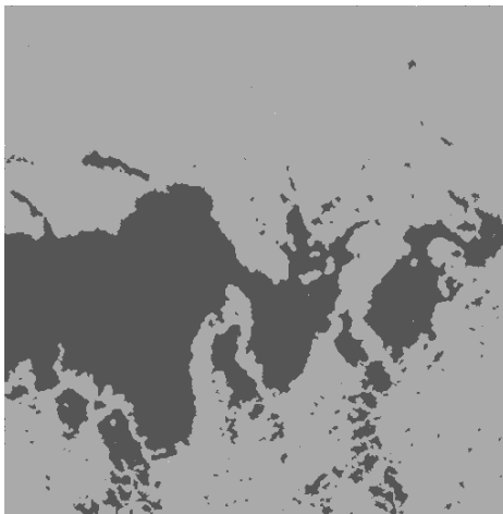
Imagen 1.4 Se toma la imagen segmentada 1.3 y se calculan dos medias en ésta imagen con los parámetros siguientes \beta = 0.035 , T = 2.5 a 50 iteraciones y el resultado fue esta imagen segmentada 1.4. Las clases fueron petróleo (negro) y no-petróleo (gris).
