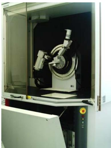
Figura 6. Esquema representativo del difractómetro Bruker axs, Advance D8.
