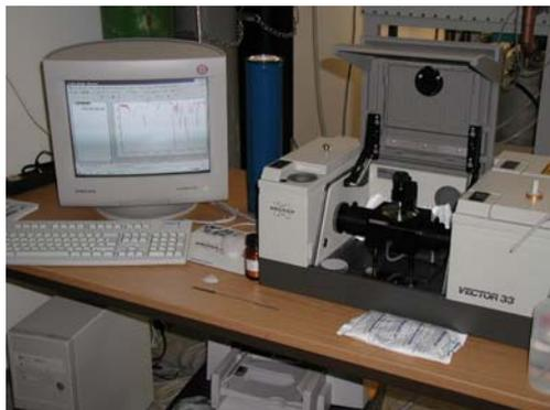
Figura 9. Equipo de espectroscopia infrarroja
