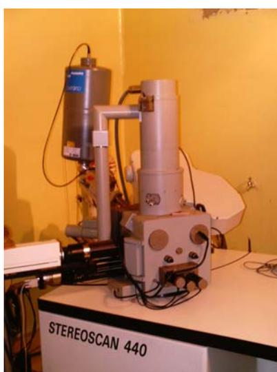
Figura 7. Microscopio Electrónico de Barrido.
