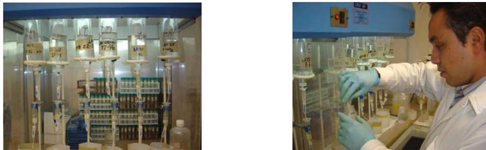
Figura 6. Filtrado y recuperación de metales en la columna
