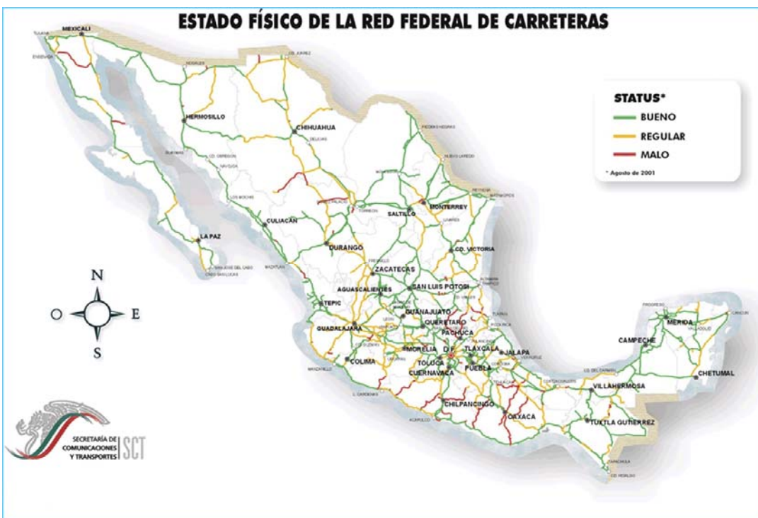
Fig. 2. Estado físico de la red federal de carreteras (Fuente: SCT)
