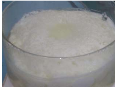
Fig. 3.17 d) Se formó un coloide en lugar del gel
