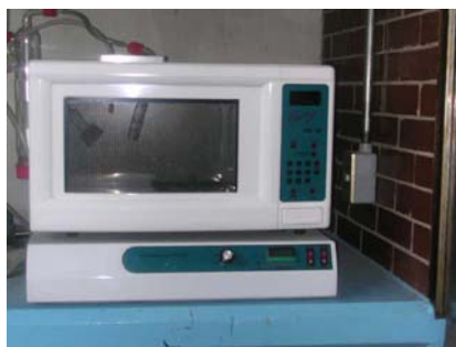
Fig.2.4 Horno de microondas, donde se deshidrata el gel
