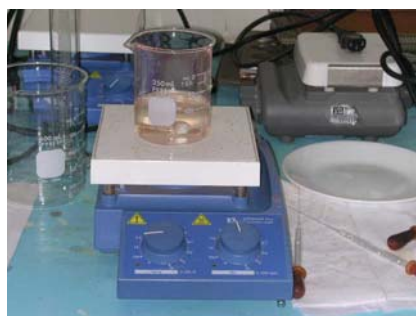
Fig.2.2 b) Disolución del ión de Hierro en ácido nítrico y agua a 450 °C
