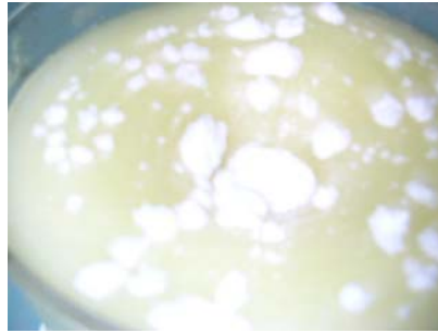
Fig. 3.17 b) Después se agregó el N- N' el cual no se disolvió por completo
