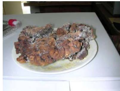
Fig. 3.4 c) El gel completamente deshidratado que es el xerogel
