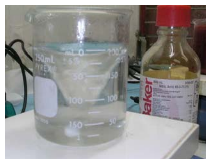
Fig. 2.2 d) Disolución del ión de Renio en ácido nítrico y agua a 405 °C
