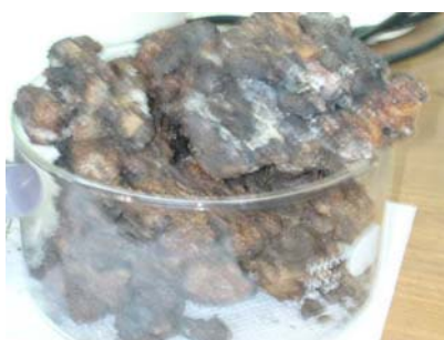
Fig. 3.15 xerogel listo para molerse en el mortero de ágata
