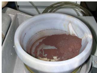
Fig.3.5 Mortero de ágata donde se molió el xerogel aproximadamente una medio hora
