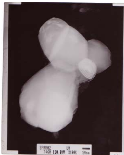
Fig 3.11 MET del xerogel, tamaño de tres partículas que están juntas
