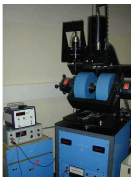
Fig. 2.16 MMV donde se realizaron las mediciones, en forma de pastilla
