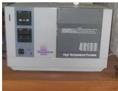
Fig. 2.6 Mufla donde se lleva cabo la sinterización del material
