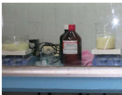
Fig. 21 b) La deshidratación se llevó a cabo en la misma parrilla dejando que se secase la disolución obteniendo el xerogel
