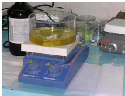
Fig.2.3 La formación del gel a una temperatura de 70 °C
