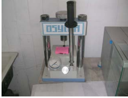
Fig.2.7 En la pastilladora se compacta el material en forma de pastilla, realizando vacío para que se compacte lo mejor posible
