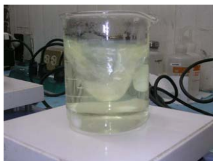
Fig. 2.2 c) Disolución del ión de Molibdeno en ácido clorhídrico y agua a 315 °C
