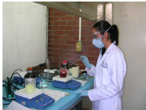
Fig.2.2 Preparación del sol, para obtener una solución transparente
