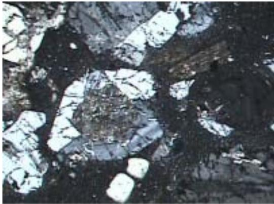
Fig.IV.10 Muestra PV-04 Piedra Encimada. Se observa fenocristales de plagioclasa, biotita, cuarzo y calcita dentro de una matriz criptocristalina.
