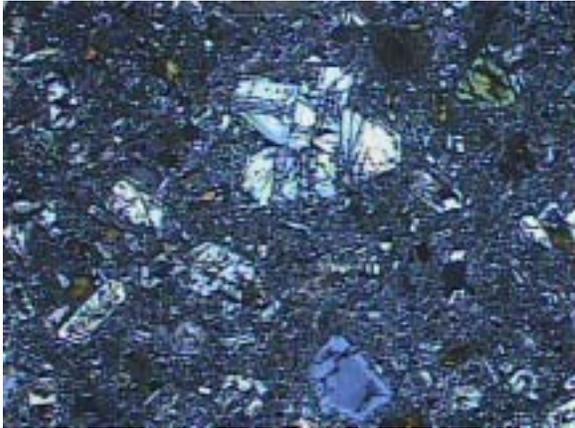
Fig. IV.3 Muestra FPA-02 Pico del Águila. Se observa fenocristales de biotita, hornblenda y plagioclasa alterada dentro de una matriz criptocristalina.
