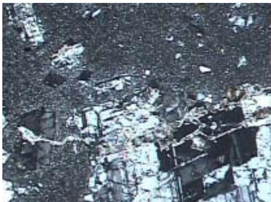
Fig. IV.11 Muestra PV-01 domo de Xonotla. Se observa fenocristales de plagioclasa fracturada dentro de una matriz criptocristalina.
