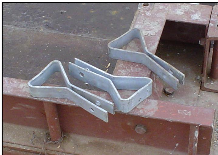
(Imagen 50) Elementos de acero galvanizados, arranques.
