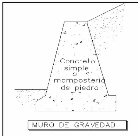
(Fig. 22) Muro de retención de gravedad.
