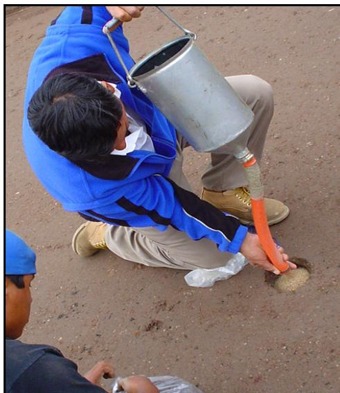
(Imagen 68) Prueba de grado de compactación del laboratorio.
