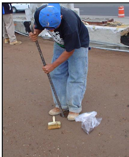
(Imagen 66) Prueba de grado de compactación del laboratorio.
