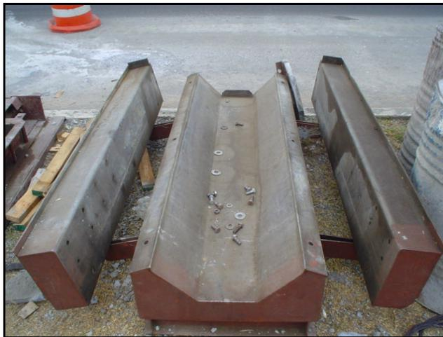
(Imagen 30) Molde para fabricación de escamas.
