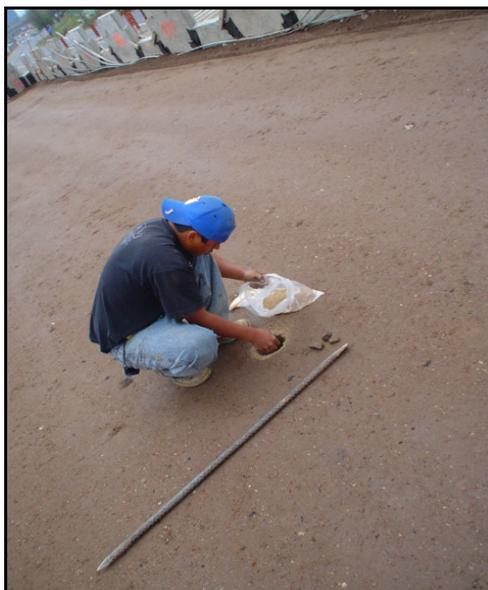
(Imagen 69) Prueba de grado de compactación del laboratorio.
