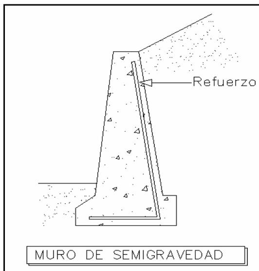
(Fig. 23) Muro de retención de semi-gravedad.
