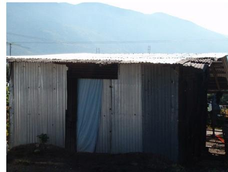
*Viviendas precarias construidas con materiales no durables tanto en los muros como en las cubiertas a base de lámina de zinc y cartón.*
