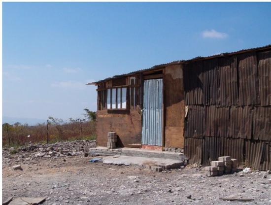
*Jardín de niños construido a base de desperdicios de madera y cubierta de lámina galvanizada*
