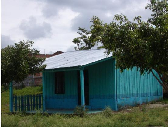
*Una muestra de la vivienda tradicional de madera con rodapié a base de block para proteger de la lluvia o humedad, así como un **corredor** al frente y cubierta de lámina galvanizada (una práctica provocada por el mercantilismo que afecta al entorno natural y a las condiciones de confort en el interior de los espacios habitables), municipio de Pujilic, Chiapas; obsérvese nuevamente el colorido.*
