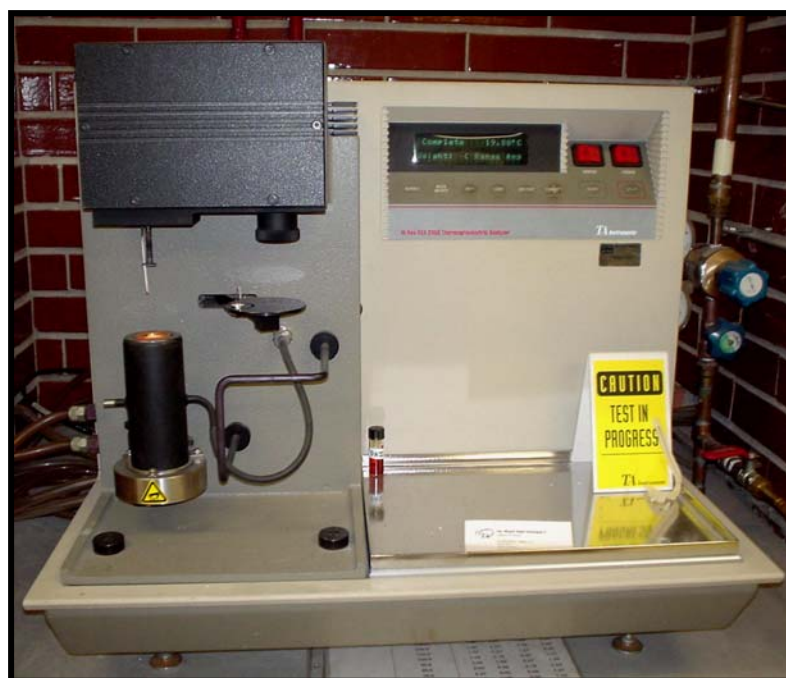
Figura 3.8. Termobalanza usada para determinar termogravimetría.
