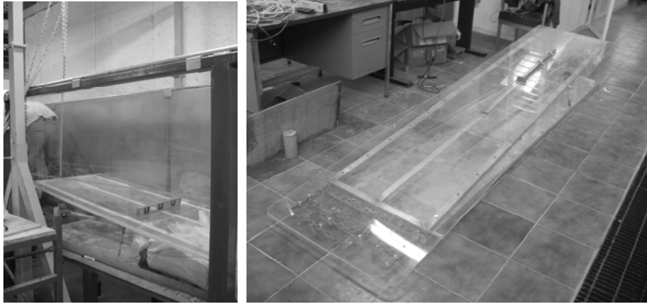
Fig. 4.2. Rampa empleada para simular la playa.
