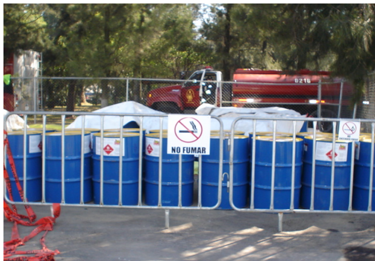
Figura 8. Imagen de los tanque de gasolina y turbosina, se observa que la zona se encuentra delimitada y con los letreros correspondientes.
