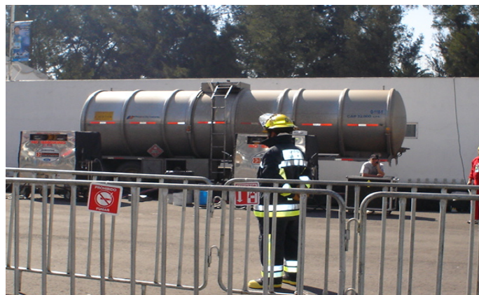
Figura 6. Imagen del autotanque de metanol, se observa que la zona está delimitada, con un bombero uniformado y con los letreros correspondientes.
