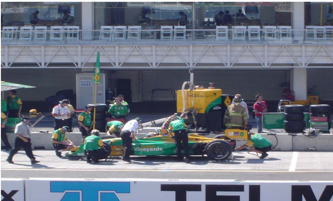
Figura 11. Imagen panorámica del área de pits de una escudería, se observa la motobomba de despacho (al centro detrás del vehículo), del lado derecho se observa un bombero correctamente protegido con el equipo adecuado.
