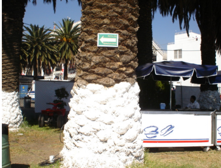
Figura 14. Imagen de un letrero de "Ruta de evacuación", observar que el tamaño y la ubicación no son las adecuadas.
