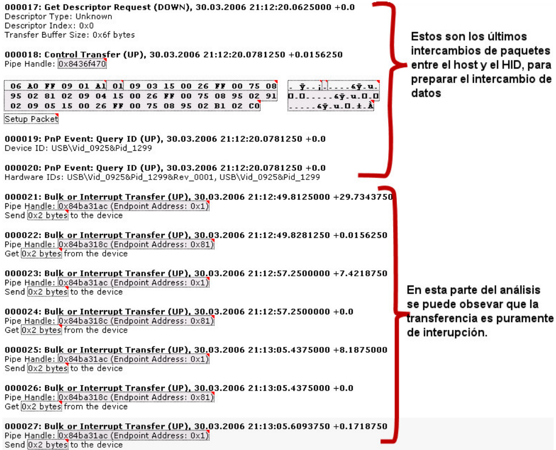
Figura 22. Análisis de la comunicación entre el HID con el firmware HID3 y el programa interfaz HIDCOMM4.
