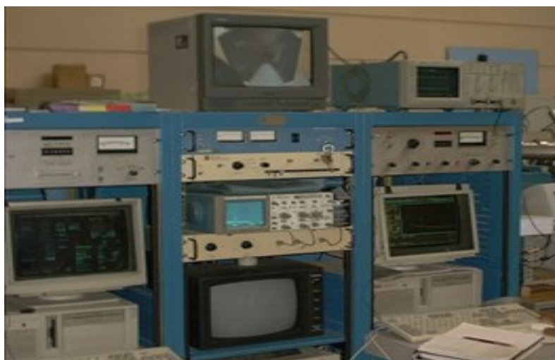
Figura 3.3.3. Imagen de la consola del acelerador Peletrón 3 MeV, donde se encuentra acoplado el analizador multicanal.
