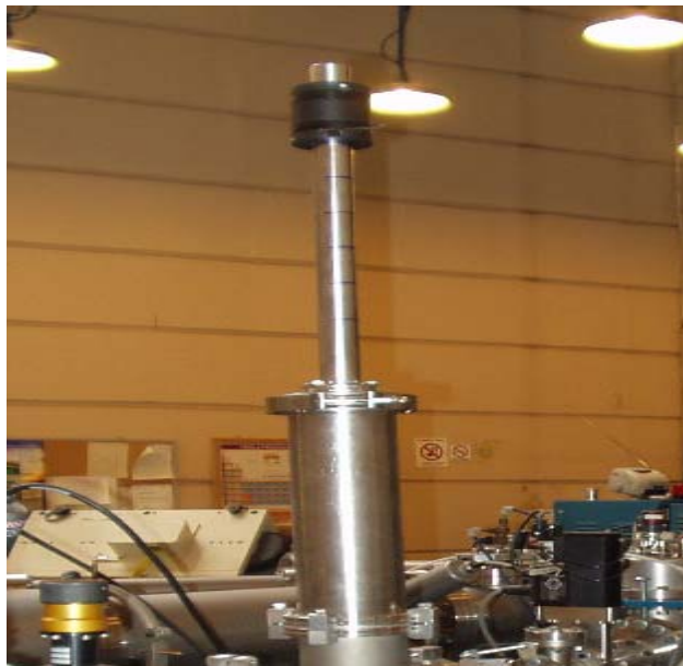
Figura 3.1.5. Fotografía de la regleta metálica en la que son colocadas las muestras de aerosoles atmosféricos durante su análisis en el acelerador Peletrón de 3 MeV .
