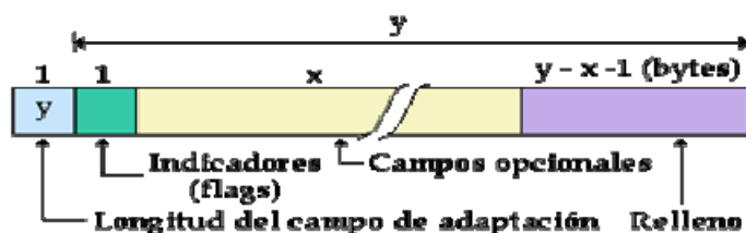
Figura 41. Detalle del campo de adaptación
