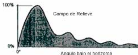
Fig 71 patrón de elevación generado por el espaciamiento desigual de las ranuras
