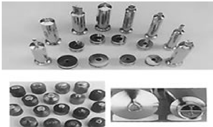
Figura 6. Diámetros estándar de los punzones y matrices.
